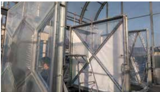
上／ドイツのミュンヘンにあるサッカースタジアム「アリアンツ・アレーナ」。 下／山口産業では、社内にプロジェクトチームを立ち上げ、ETFEフィルムの 実物に近いサイズのモックアップを作成し、技術を検証している。
